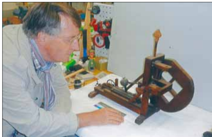
Mendes Modell einer Feilenhaumaschine (TU BA Freiberg) Foto: privat
